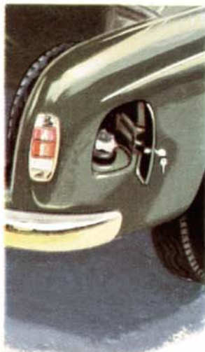
Eine verschließbare Klappe sichert den abgedeckten Tank-Einfüllstutzen gegen unerwünschte Zugriffe.
